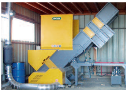
Primjena: Iverice, palete Rješenje: LR1400 Oprema: Prekretni stol Lokacija: Francuska
