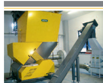
Primjena: Usitnjavanje drvenih paleta Rješenje: LR1400 Oprema: Transportni sustav Lokacija: Njemačka
