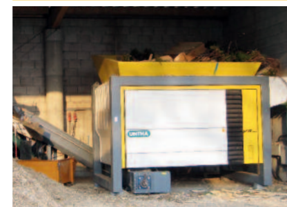
Primjena: Palete Rješenje: VR60 Oprema: Pužni transporter Lokacija: Njemačka
